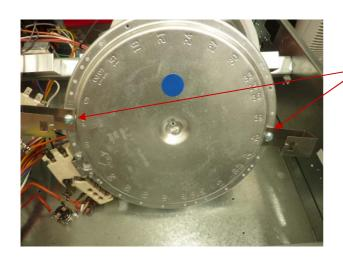
WHEN REPLACING THE ELEMENT ALWAYS ENSURE THAT THE CLIPS ARE FITTED ON THE NEW ELEMENT IN THE SAME POSITION
